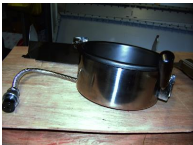
Abgenommener Kessel mit Stromkabel
